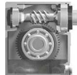
Специальный корпус, предназначенный для сохранения надлежащей смазки при малом кол-ве масла во избежание внутреннего давления.
